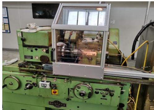
Eingreifschutz für Schleifmaschinen. Verschiebbare Schutzhaube mit elektrischer Zuhaltung.
