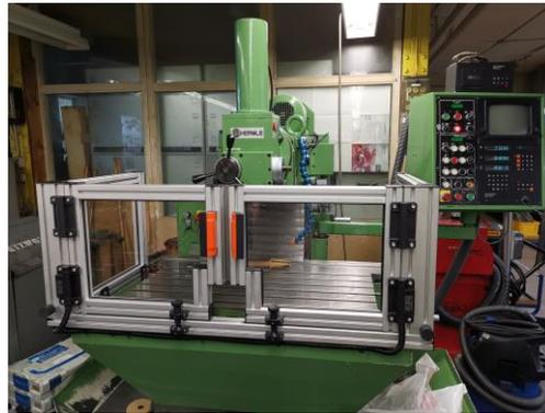
Schutzeinhausung mit Klapptüren für CNC-Fräsmaschinen. Auf Wunsch mit rückseitiger Verkleidung.
